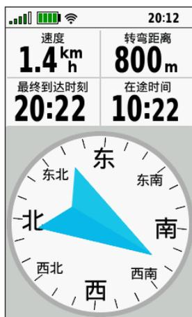
使用罗盘导航至目的地时，▲ 将始终指向目的地方向，并不因移动方向而改变。当▲ 指向电子罗盘正上方，您
