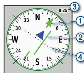
航向指针 ① 表示您与目的地的路线的关系。航向偏差指示器(CDI) ② 提供航向偏离(右或左)的指示。标尺 ③ 指路线偏离指示器上的点 ④ 的距离，它告诉您偏离路线的距离。
